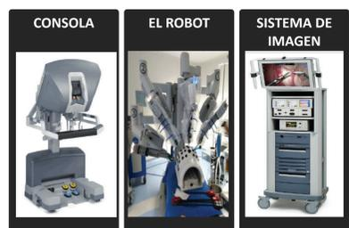
Figura 3. Los tres componentes del Sistema quirúrgico robótico da Vinci®: A. Consola del cirujano; B. Robot (brazos articulados); C. Sistema de imagen.
