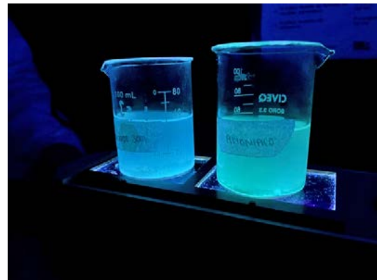
Figura 1. Muestras de puntos cuánticos de carbono bajo radiación UV. Fuente: Elaboración propia.
