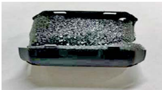
Figura 2. Barrera en malla metálica para ríos: la acumulación de matrices incrementa el tiempo de contacto agua-superficie activa, favorece la colonización por comunidades de microorganismos y promueve la degradación de contaminantes por contacto. Fuente: Elaboración propia con base en [5].
