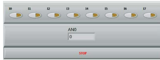
Figura 6. Panel frontal del sistema de 1 entrada analógica y 8 salidas digitales. Fuente: Elaboración propia.
