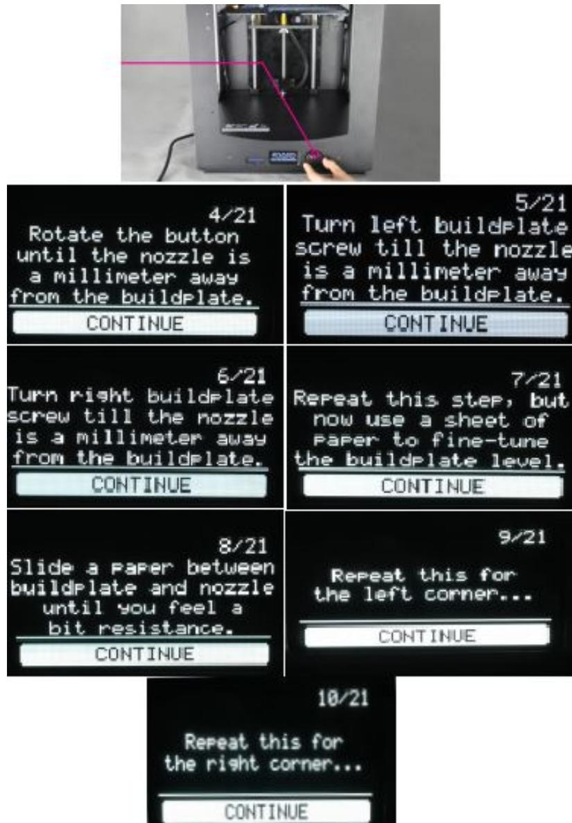
Figura 4: Nivelación de la placa de construcción.
