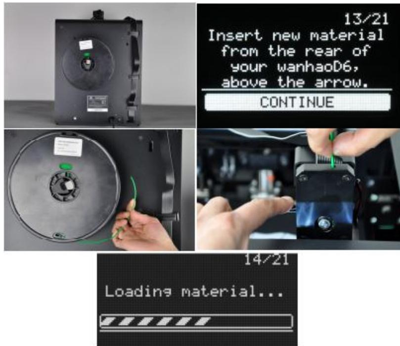
Figura 5: Carga de material en el filamento.
