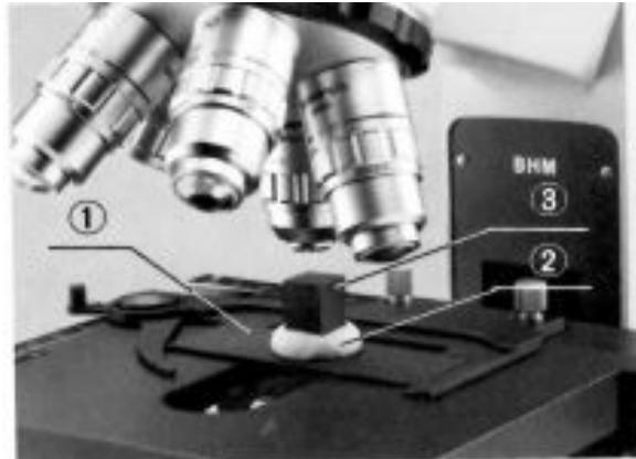
Figura 30: Colocación de la muestra en la placa deslizable de metal.
