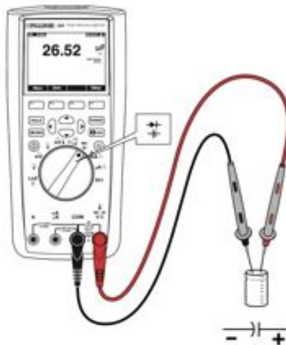
Figura 12: Medición de capacitancia.
