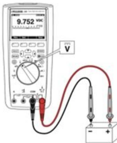
Figura 8: Medición de voltaje CC.
