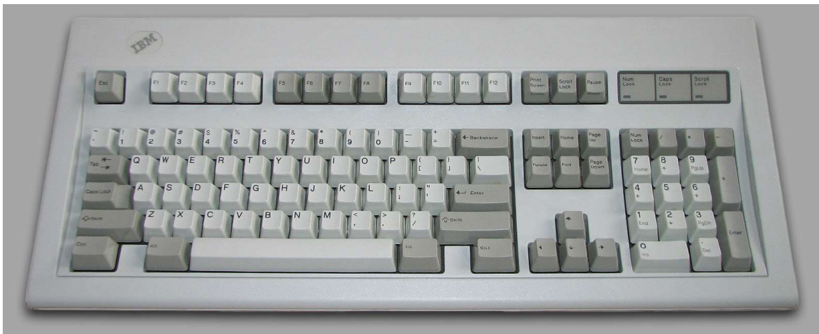
Teclado IBM Modelo M, distribución ANSI
